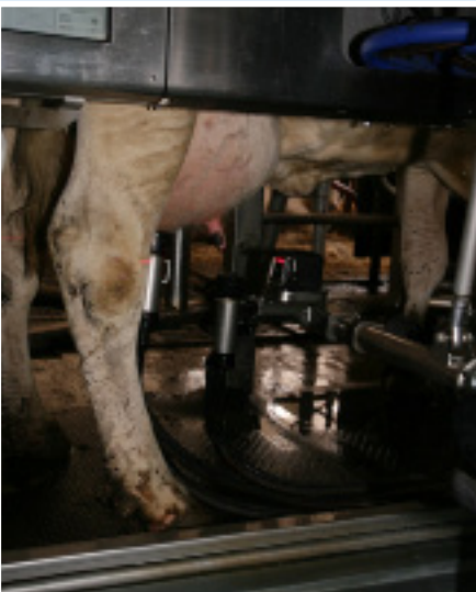
Робот розроблено так, щоб він вмів сам віднаходити частки вимені та видоювати їх. При цьому робот слідкує за вмістом молока в частці, через що маститу у корів на добровільному доїнні не спостерігається
